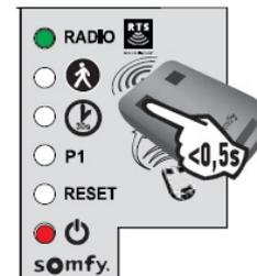
1. Drücken Sie die Taste
