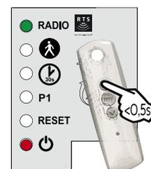
1. Drücken Sie die Taste
